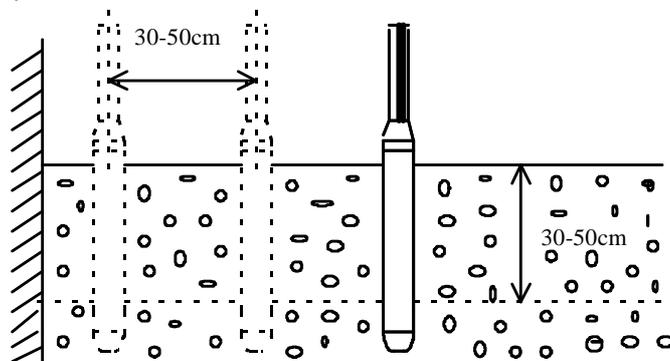
Le béton est globalement vibré lorsque la surface autour de l'aiguille devient brillante et qu'aucune grosse bulle d'air ne remonte plus à la surface.
