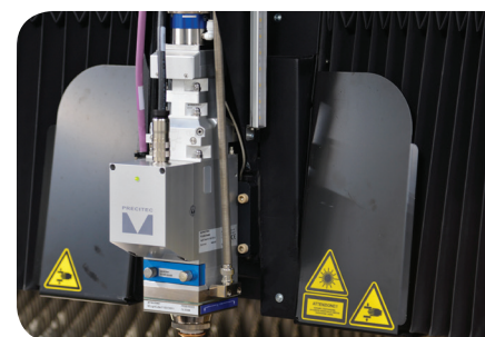
Tête de découpe avec focale optique motorisée
